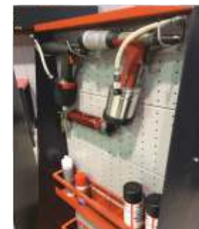
Particolare di un allestimento con perni porta attrezzatura e mensole porta flaconi e bombole precaricate.
