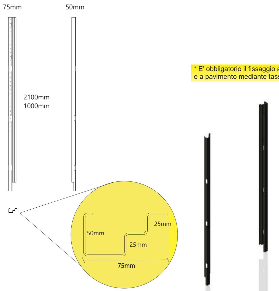
Montanti verticali funzionali con profilo a scaletta per un facile e preciso fissaggio di tutti i componenti della parete attrezzata.
